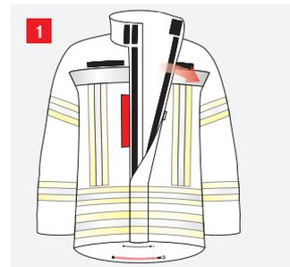
Der Rosenbauer IRS Gurt wird durch den Gurtunnel gefädelt.
