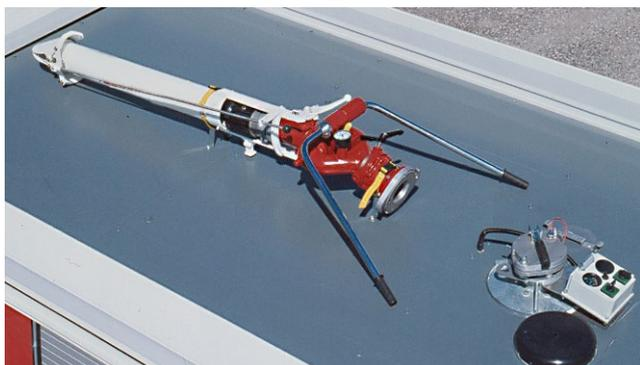
RM24 in abgekuppelter Ablageposition
