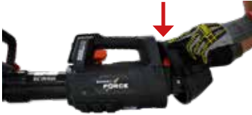
Abb 3: Kontrolle der Dichtung sowie des Gehäuses
