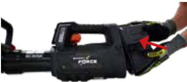
Abb 4: IP 68 Akkucover zuerst am oberen Rand an das Gehäuse andrücken
